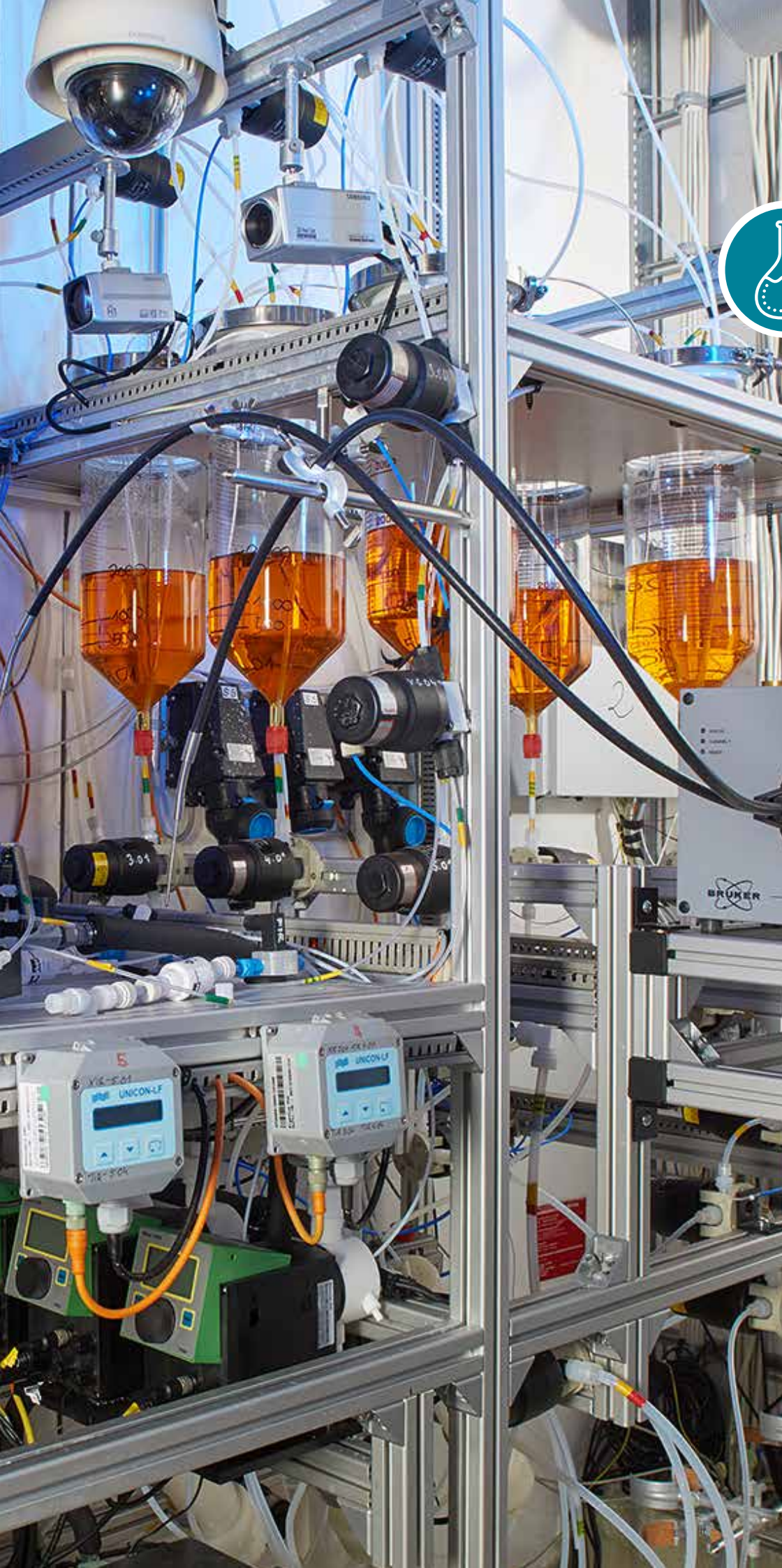
Lichtleiterbasierte ortsaufgelöste Prozess- spektroskopie in Mikro- reaktorprozessen.
