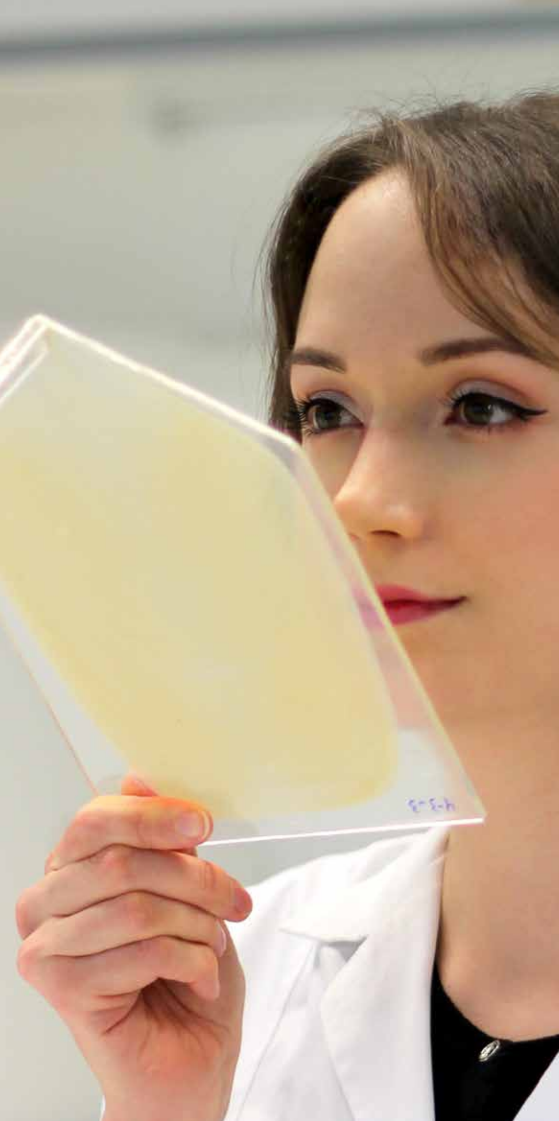
Sandwichprüfkörper mit Rezyklatkern (braun) und einem Hautmaterial ohne geruchsreduzierende Additive bei der sensorischen Bewertung.
