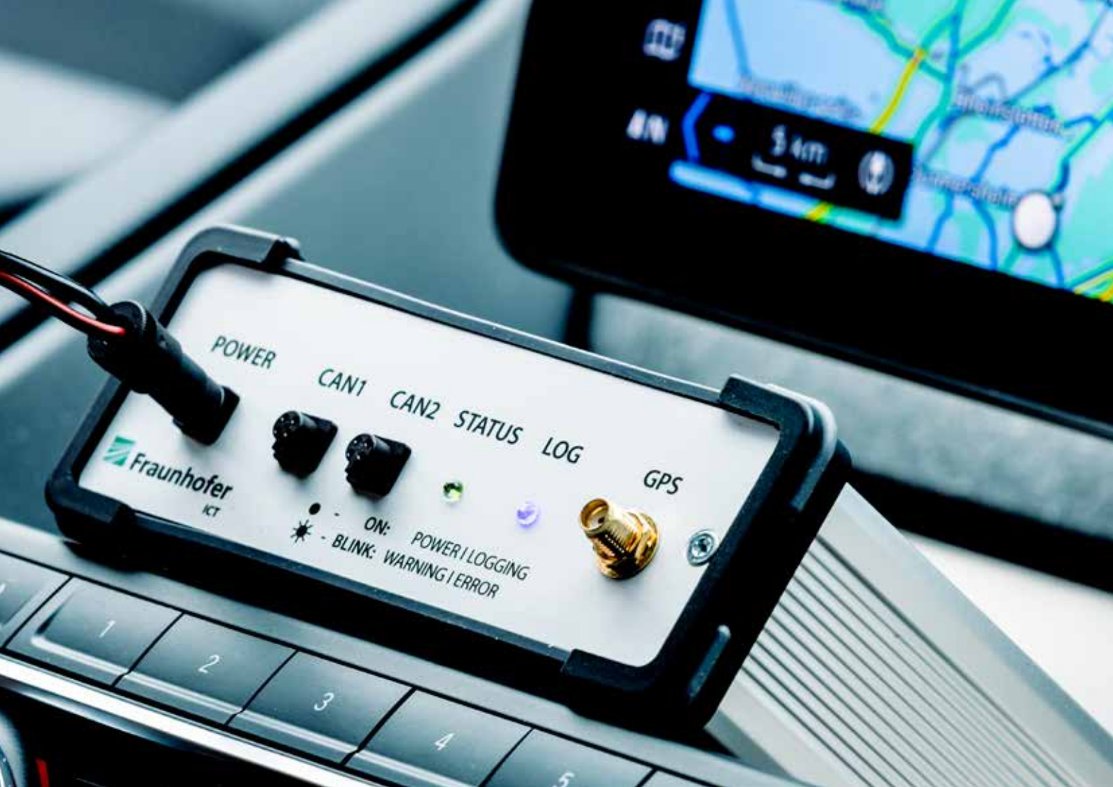
Datenlogger zur autarken Aufzeichnung unterschiedlichster Messdaten in Pkw, Lkw oder Produktionsanlagen.
